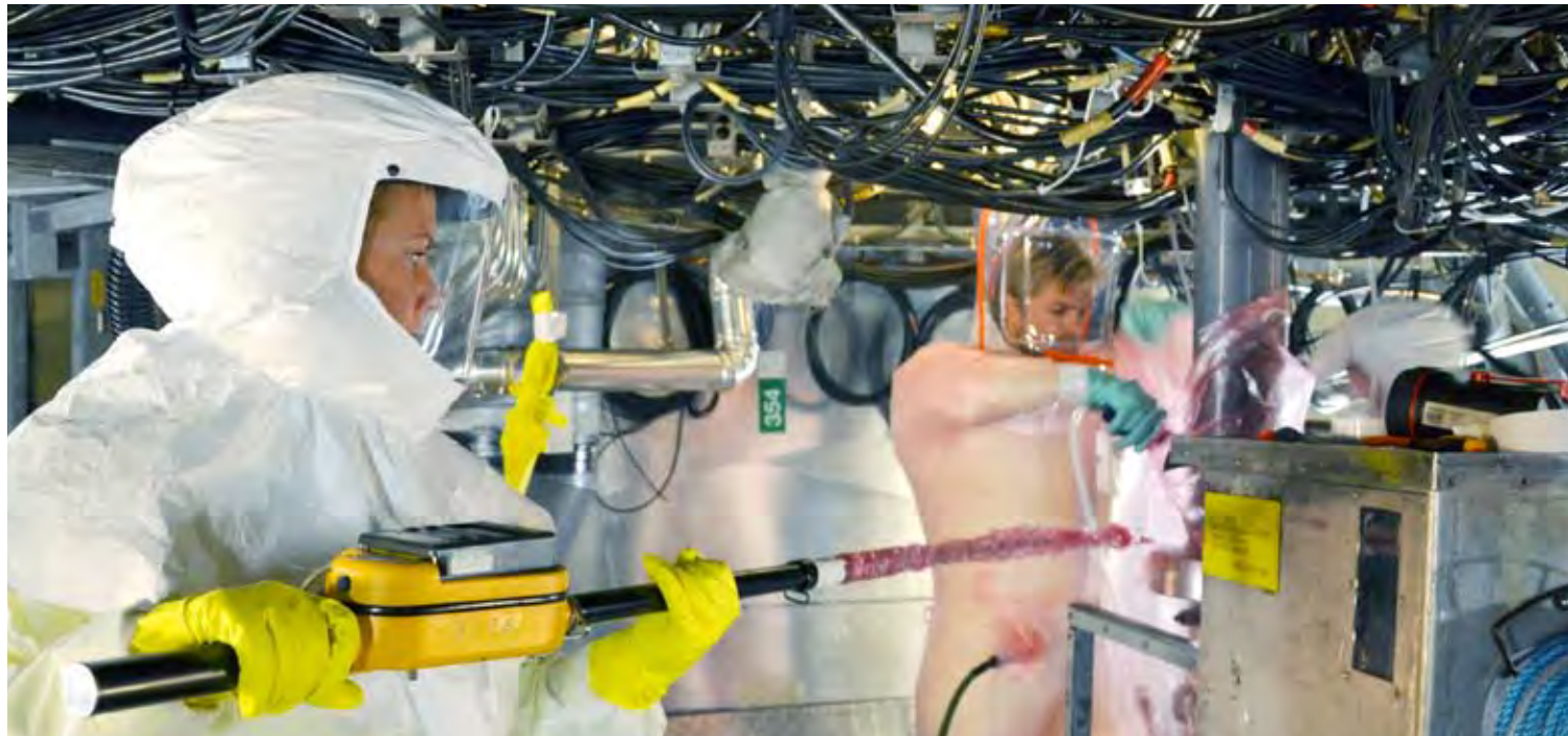
Vissa arbeten på ett kärnkraftverk kräver extra skyddsutrustning mot kontaminering av radioaktiva partiklar. En skyddstekniker använder här ett dosratinstrument för att kontrollera strålningsnivån.
